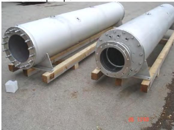
Saugmäntel DN 400 für Unterwasserpumpen
