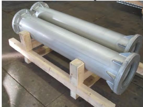
Verbindungsänder für den Pumpenbau, Werkstoff: 1.4462 (Duplex)
