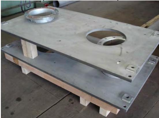
Schweißrohlinge zur weiteren mechanischen Bearbeitung
