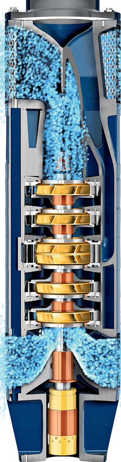
Strömungsprinzip der doppelflutigen HDM Technologie ▶
